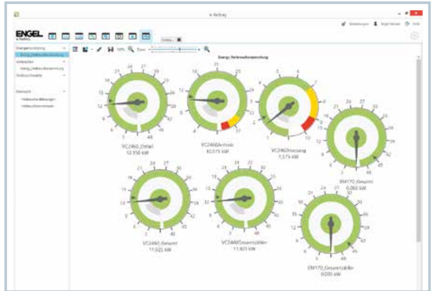
Bild 5. Die Vernetzung der Maschinen bringt auch für das Energiemanagement Vorteile mit sich. Das neue „Energy“-Modul der MES-Lösung e-factory macht den aktuellen Energiebedarf der einzelnen Verbraucher transparent (© Engel)
