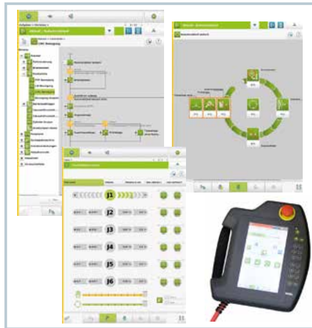
Bild 2. Die vollständige Steuerungsintegration ermöglicht eine einfache Parametrierung und Bedienung der easix-Mehrachsenroboter. Die Engel-Lösung ermöglicht auch für komplexe Fertigungsprozesse die objektorientierte grafische Erstellung von Ablaufsequenzen, wofür die Teach-Kenntnisse der viper-Linearroboter ausreichen (Bild: Engel)
