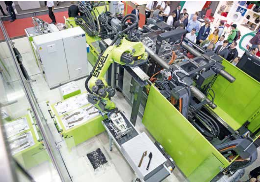
Vollständig integriert: Eine Spritzgießmaschine Engel duo combi M produzierte während der Fakuma 2015 Dekorelemente für den Autoinnenraum. Der Engel easix Industrieroboter übernahm das Handling der Echtholzurniere und der Fertigteile (Bild: Engel)
