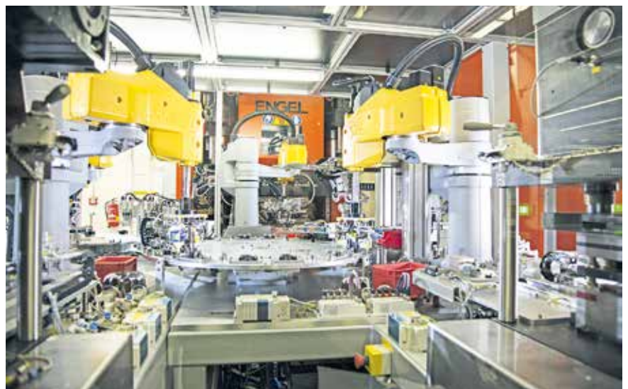
Bild 4. Mit Scara-Robotern erweitert Engel seine easix-Reihe erneut. Diese finden Anwendung für schnelle „Pick and Place“-Aufgaben, wie die effiziente Vorbestückung von Greifern oder Pufferaufnahmen (Bild: Engel)
