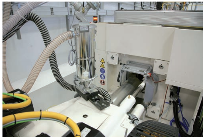
Der Plastifizierzylinder wurde mit einer Kapselung versehen, durch die die erwärmte Umgebungsluft abgesaugt wird, ohne den Wärmehaushalt des Reinraums zu belasten.
