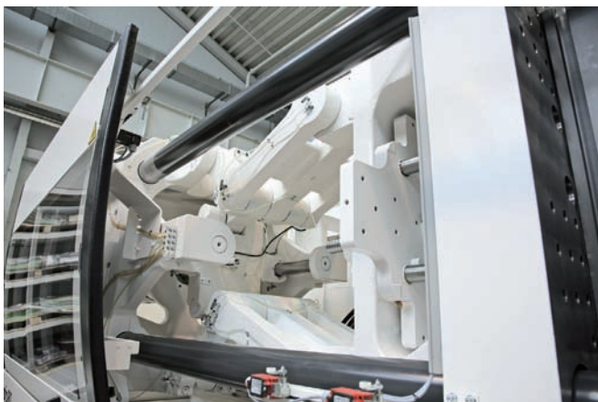
Ölgeschmierte Kniehebel-Schließeinheit und Reinraumbetrieb müssen kein Widerspruch sein. Hier ist die Schließeinheiten mit einem geschlossenen Schmiermittelkreislauf – inklusive Rückführung des Lecköls – ausgerüstet.
