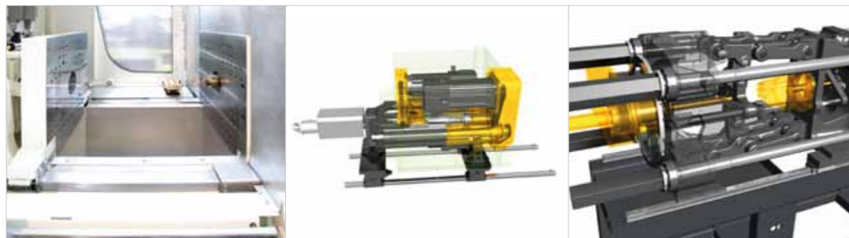
Komplett fettfreie Schließeinheit durch abgedeckte Führungen bei einer ENGEL victory
