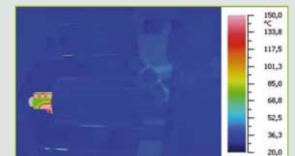
Das Wärmekamerabild zeigt es deutlich: Durch die patentierte GMP-Massezylinderabsaugung wird die Wärmeabgabe in den Reinraum deutlich reduziert.
