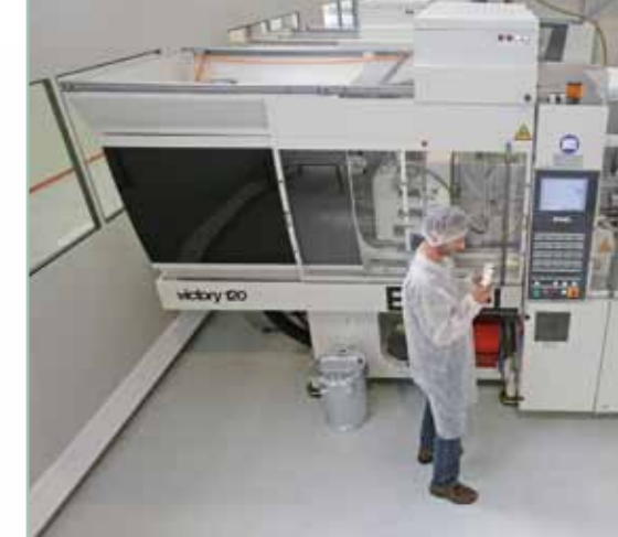
Satellitenkonzept: Die Spritzgießmaschine steht außerhalb des Reinraums
