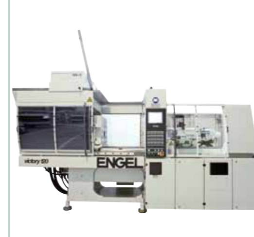
Reinraummodul (Filter-Fan-Unit) komplett integriert
