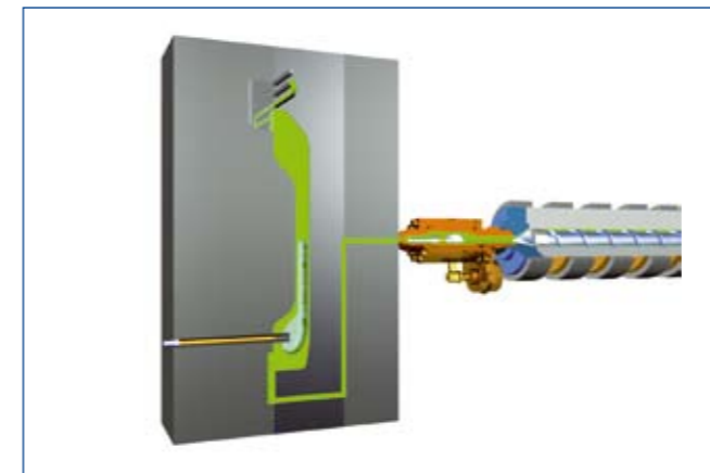
Verfahrensschritt 3: Die Verbindung zur Nebenkavität wird geöffnet. Gleichzeitig wird die Fluidinjektion aktiviert. Kunststoffschmelze aus dem Inneren wird in die Nebenkavität verdrängt.
