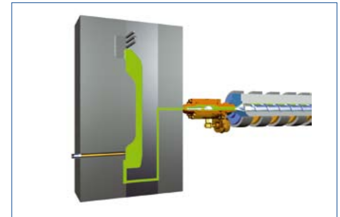
Verfahrensschritt 2: Kunststoffschmelze wird eingespritzt. Die Formkavität wird vollständig gefüllt. Die Verbindung zur Nebenkavität ist geschlossen.
