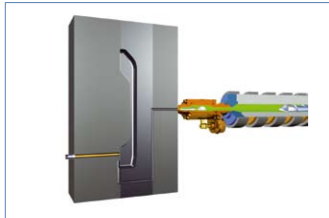
Verfahrensschritt 1: Spritzaggregat mit Verschlussdüse geschlossen, Material wird aufdosiert
