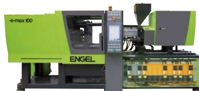
Maximale Energie-Effizienz dank State of the Art Technologie: Beim Abbremsen aller Antriebe wird die Energie wieder in das Netz rückgeführt
