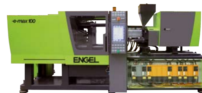
Maximale Energie-Effizienz dank State of the Art Technologie: Beim Abbremsen aller Antriebe wird die Energie wieder in das Netz rückgeführt.
