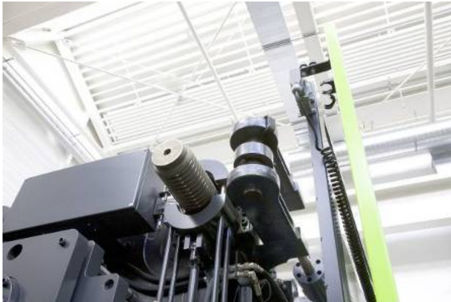
Bild 2: Die ENGEL duo pico besteht durch ein kompaktes 2-Platten-Schließsystem
