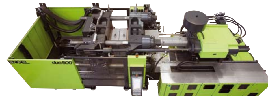
Kompakte Kraft auf nur 7210 mm Länge. ENGEL duo 2050/500 pico. Dank optimierter Ergonomie ist der Werkzeugbereich sehr gut zugänglich.
