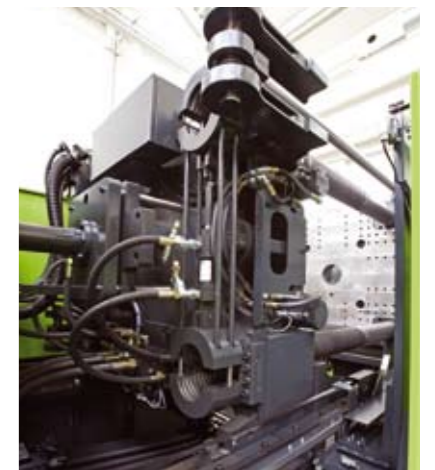
Kürzeste Trockenlaufzeiten dank synchronisierter Verriegelung und geringen bewegten Massen. Auch der Auswerferbereich ist optimal zugänglich.
