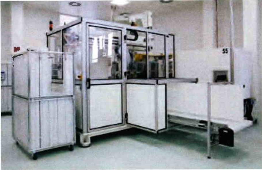
Drei Engel e-max 180 produzieren die Racks, in denen die Tips und Cups abgelegt werden.
