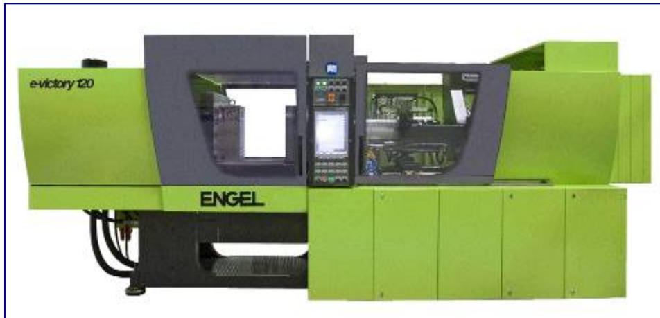
Bild 2: Die ENGEL e-victory mit Servohydraulik
