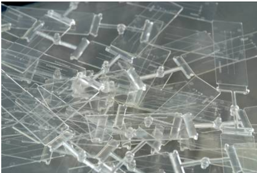
Mikrostrukturierte Kunststoffplatten mit feinen Kanälen und Stegen aus Cycloolefin-Copolymer (COC), hergestellt in einem 2-fach-Werkzeug auf der neuen holmlosen und GMP-qualifizierten „Medical“-Spritzgießmaschine ENGEL e-victory 80/50
