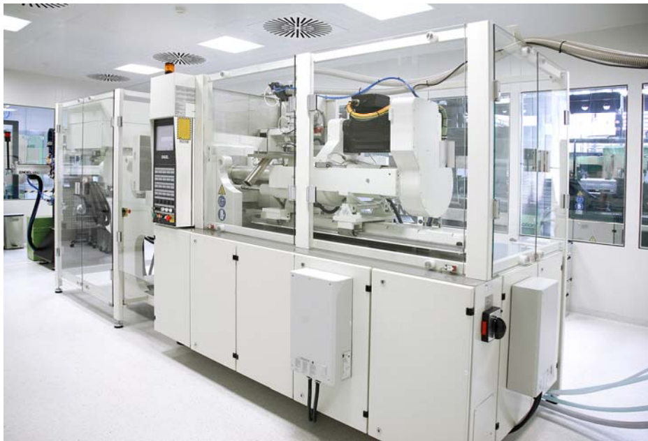
GMP-qualifizierte Spritzgießmaschine ENGEL e-victory 80/50 in Medical-Ausführung mit einem kleinen Sechsbachsenroboter TX40 von Staubli
