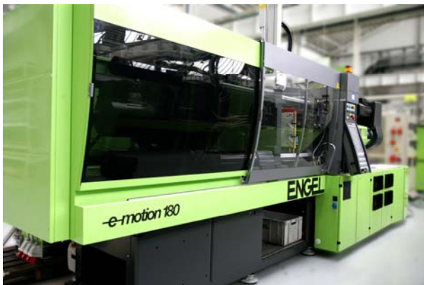
Bild 2: ENGEL e-motion 740/180 T rubber zur Herstellung von Membranen aus EPDM
