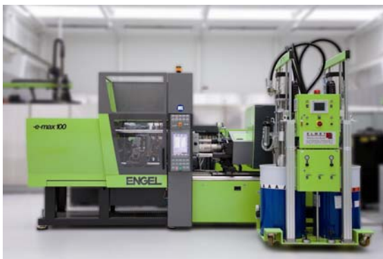
Bild 1: ENGEL e-max 200/100 LIM zur Herstellung von LSR-Ventilen (li.)
