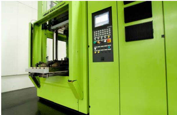
Bild 2: ENGEL elast 1500/400 compact – Gezeigt wurde die Produktion einer EPDM-Tülle
