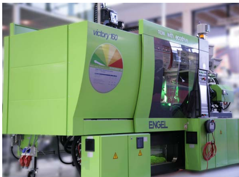
Bild 2: ENGEL victory 160 mit ecodrive zur Herstellung eines Lagebocks für den Sanitärbereich (re.).
