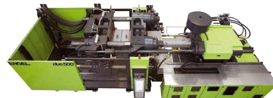
Машина ENGEL duo 2050/500 pico. Длина машины – 7,2 м. Оптимизированная эргономичная конструкция обеспечивает полностью свободный доступ к пресс-форме.
