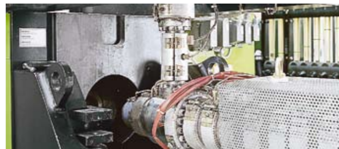
Вертикальный узел впрыска с двухкомпонентным соплом (стандартное дополнительное оснащение для двухкомпонентного литья).
