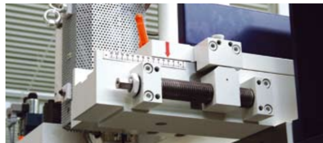
Настраиваемая каретка для позиционирования узла впрыска над пресс-формой.
