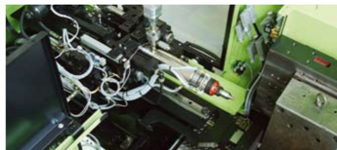
Линейная направляющая, присоединенная к основной раме, позволяет легко настроить требуемое положение второго узла впрыска.
