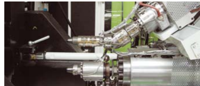
Детальный вид расположения сопел вертикального узла впрыска, расположенного под наклоном. Расстояние между соплами на модельной линейке машин стандартизировано: 130, 160 и 200 мм.
