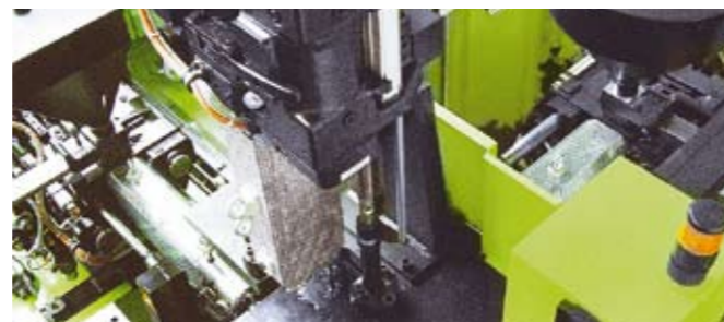
Простая бесколонная система запираия идеально подходит для размещения дополнительных узлов впрыска.
