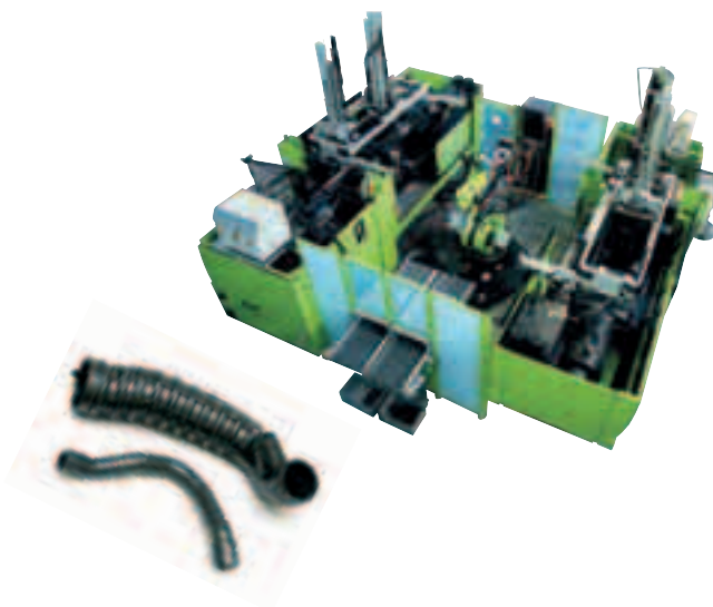
Шестиосевой робот работает с двумя машинами ENGEL elast при производстве воздухозаборных труб для автомобильной отрасли в компании AR-TEX
