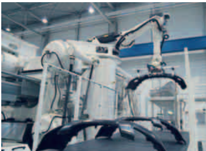
Производство бамперов фирмы Mobis: полностью автоматизированный комплекс, оснащенный 6-осевым роботом
