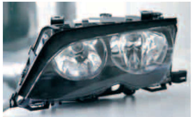
Рассеивающие линзы для автомобиля BMW третьей серии, произведенные на заводе ZKW Slovakia
