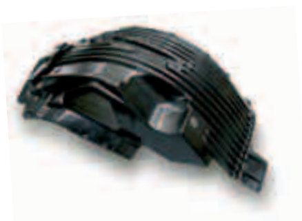
Подкрылки грузовика, оптимизированные по акустическим характеристикам
