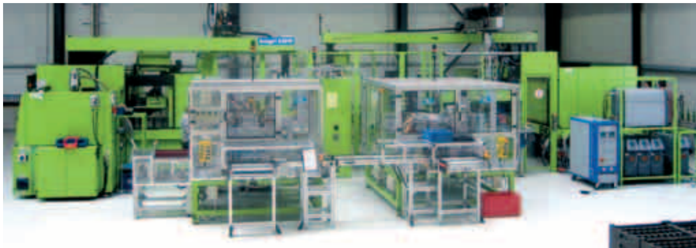
Комплекс из двух ТПА, производящий вихревые заслонки с использованием двухкомпонентной технологии, компания Schneegans
