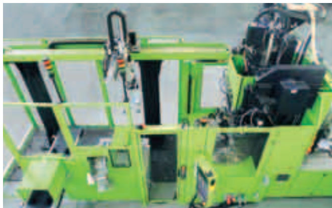
Производственная ячейка с 90-тонной вертикальной машиной ENGEL insert с автоматической вставкой закладных элементов и дальнейшим удалением готовой детали
