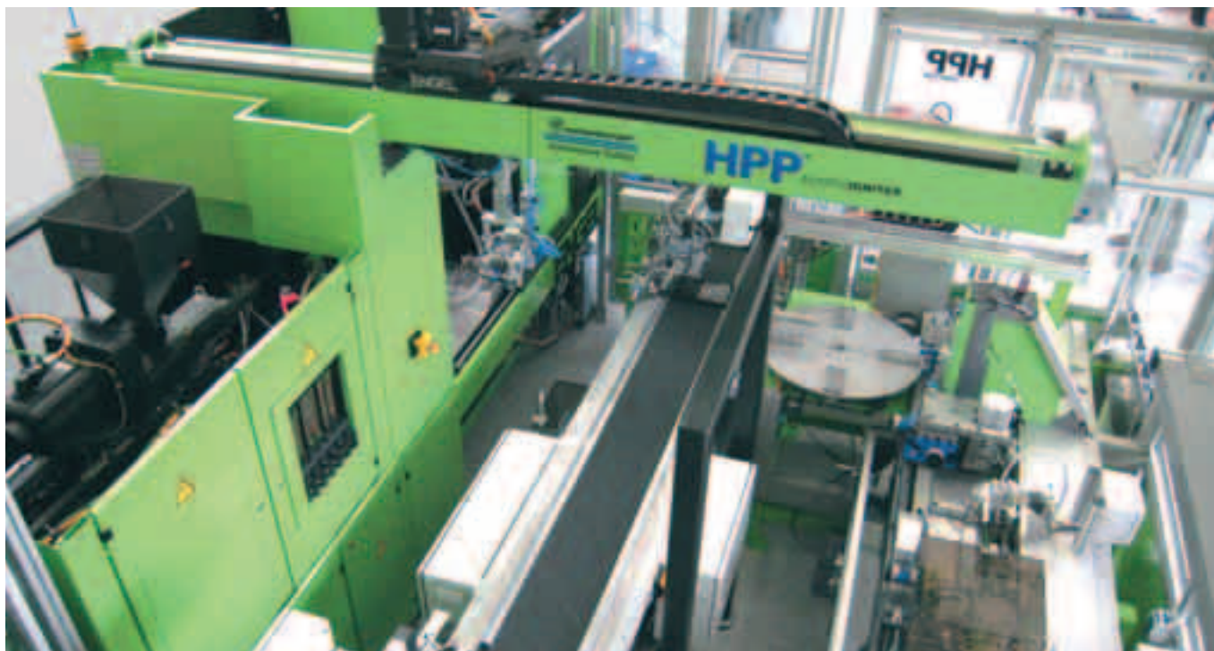
Производственная ячейка для изготовления и тестирования пиротехнических компонентов автомобиля, фирма Hirtenberger
