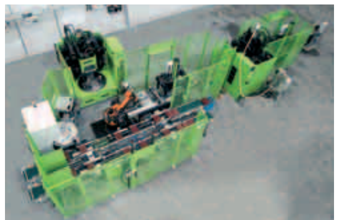
Комплексная система ENGEL для штамповки и заливки компонентов корпуса замка
