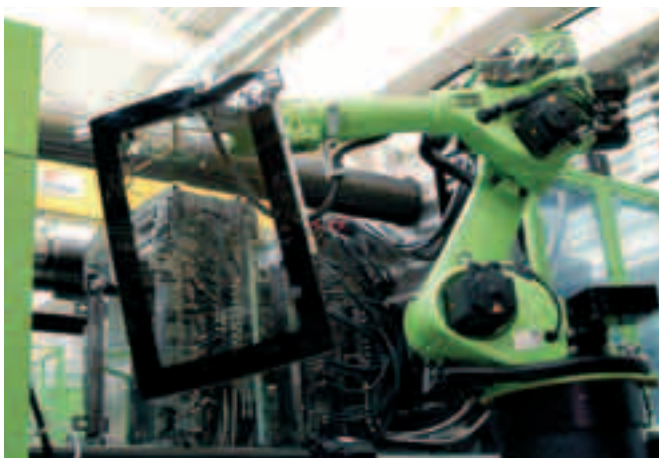
Производство двухкомпонентных панорамных окон с помощью технологии ENGEL glazemelt
