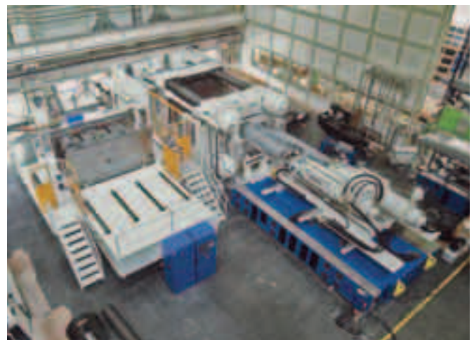
Встроенная система смены пресс-форм сокращает продолжительность установки, увеличивает возможности машины и повышает эффективность производства
