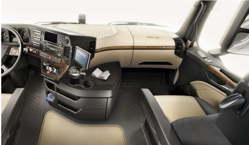
Mehr Komfort im Fahrerhaus: Blenden und Abdeckungen des neuen Mercedes-Benz Actros werden im Dolphin-Verfahren mit weicher Softtouch-Oberfläche gefertigt. (Bild: Daimler)
