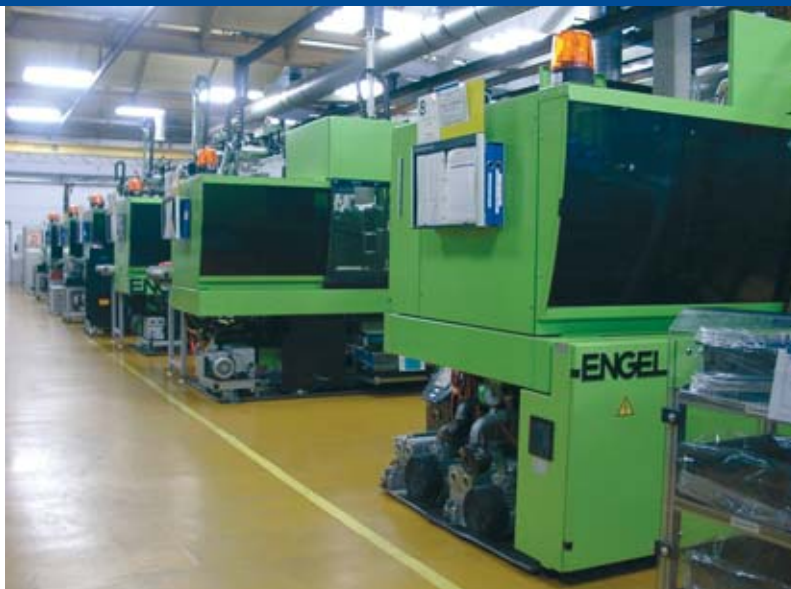
Serienproduktion der 2K-Deckel für die Lambdasonden-Steckverbindung bei Bosch in Waiblingen – selbstverständlich voll automatisiert und mannlos (links). Die Produktionszelle für den 2K-PA-LSR-Verbund reiht sich in die Produktionsstraße mit weiteren Engel-LIM-Maschinen ein (rechts).
