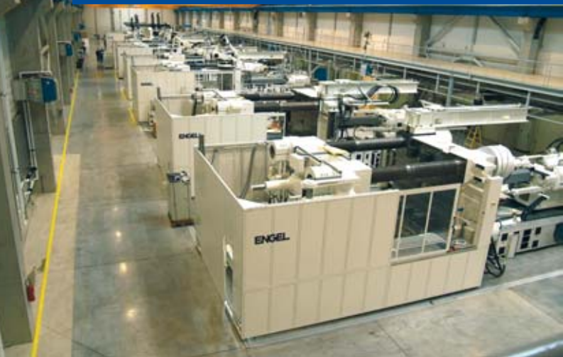
Mobis – Das im Jahr 2006 eröffnete Produktionswerk des größten koreanischen Autozulieferbetriebs ist auf die Just-in-time-Zulieferung von Front-, Heck- und Cockpit-Modulen für KIA-Automobile spezialisiert. Großmaschinen ENGEL DUO produzieren die Hauptkomponenten.
