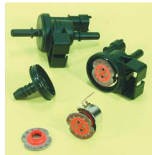
Ankerplatte (unten links) für Tankentlüftungsventil: Die rote Silikonmembran muss enormer mechanischer Belastung standhalten; die braun-grauen Silikonpartien außen haben eine Dämpferfunktion beim getakteten Schalten der Ankerplatte.
