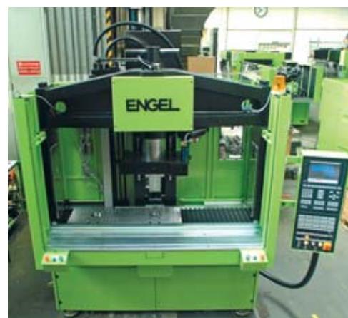
Als Alternative zur Standardausführung mit Rundtisch sind Insert-Maschinen auch in Sonderausführung mit Schiebetisch lieferbar.
