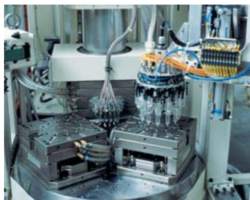
Die freie Zugänglichkeit der Rundtisch-Schließeinheit ist die optimale Voraussetzung zum Anbau von Handlinggeräten.
