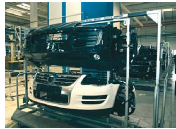
Plastic Omnium – Werkleiter Vladimir Smolka (rechts) präsentiert Mastex-Verkaufsleiter Martin Janco Pkw-Frontmodule für Porsche und VW. Bilder rechts: Acht ENGEL DUO produzieren die Großkomponenten (oben). – Alle Spritzgießwerkzeuge sind für den schnellen Werkzeugwechsel per Kran adaptiert (Mitte). – Pkw-Front-Module, fertig für die Just-in-time-Lieferung an VW Bratislava (unten).
