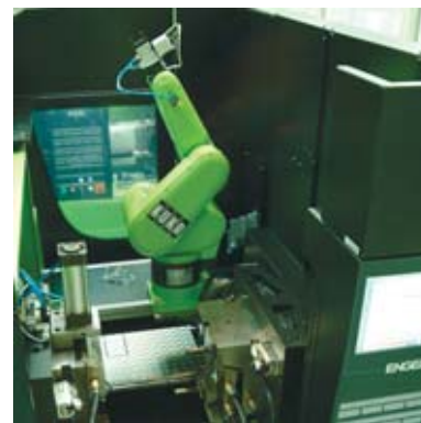
Linearroboter auf Spritzgießmaschinen für Pick and Place-Aufgaben sind ein bekanntes Bild (links) – aber auch Knickarmroboter lassen sich innerhalb der Maschinen-Schutzverkleidung im Werkzeugbereich integrieren (rechts).
