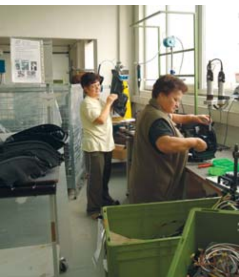
JIT Plastic – Das Unternehmen bietet nicht nur Spritzgussteile, sondern auch Vormontage – hier z.B. die Montage von Kabeldurchführungen und Einsätzen in Pkw-Scheinwerfergehäuse.
