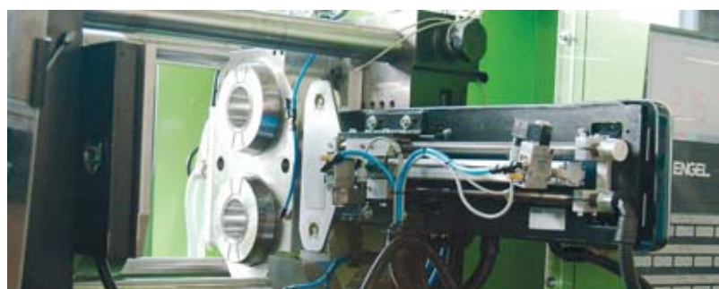
Ist hohe Geschwindigkeit gefordert, sind Linearroboter den Knickarmrobotern überlegen, zumal eine Linearachse heute – wie im Bild – als hochdynamische Servoachse Fahrgeschwindigkeiten von bis zu 10 m/s erreicht.
