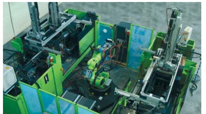
Produktionszelle mit Elast-Maschinen: Die Positionen für Linearroboter über den Werkzeugen sind durch Bürstvorrichtungen besetzt – Einlege- und Entnahmearbeiten übernimmt ein Knickarmroboter zwischen den Maschinen.
