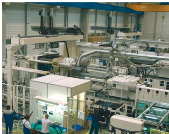
Mobis – In der Produktion werden unterschiedliche Robotersysteme gemäß ihren unterschiedlichen „Talenten“ eingesetzt: Lineargeräte für lange Transportwege und simultanes Einlegen und Entnehmen (links) – Industrieroboter für komplexe 3D-Bewegungen auf engem Raum (rechts).
