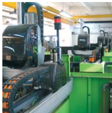
Linearroboter auf Spritzgießmaschinen für Pick and Place-Aufgaben sind ein bekanntes Bild (links) – aber auch Knickarmroboter lassen sich innerhalb der Maschinen-Schutzverkleidung im Werkzeugbereich integrieren (rechts).
