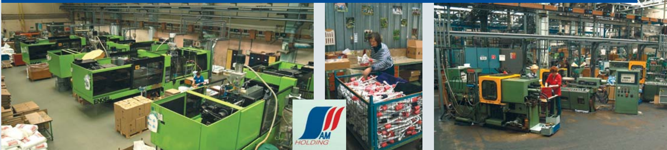
SAM Holding – Insgesamt 84 Spritzgießmaschinen, davon 47 Engel-Maschinen, dienen SAM zur Herstellung des umfangreichen Teilespektrums an Sanitärausrüstungen. – Bild rechts: Auch einige ältere Engel-Maschinen sind Dank der ausgezeichneten Instandhaltung noch im täglichen Produktionseinsatz (siehe dazu auch Bericht auf Seite 11).
