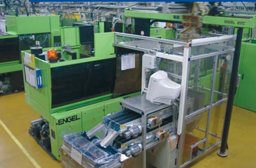
Serienproduktion der 2K-Deckel für die Lambdasonden-Steckverbindung bei Bosch in Waiblingen – selbstverständlich voll automatisiert und mannlos (links). Die Produktionszelle für den 2K-PA-LSR-Verbund reiht sich in die Produktionsstraße mit weiteren Engel-LIM-Maschinen ein (rechts).
