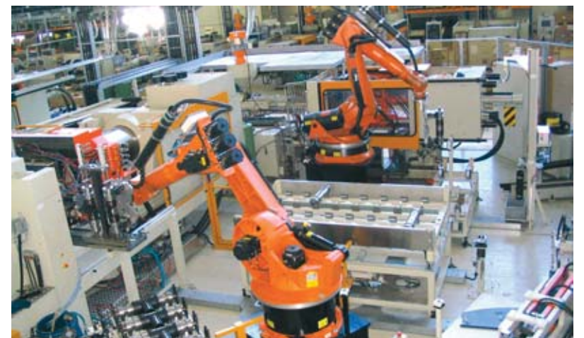
Produktionszelle für Fittings mit integrierten Heizwendeln: Die für den Gesamtprozess notwendigen komplexen Zusatzarbeiten außerhalb der beiden Spritzgießmaschinen waren nur mit Knickarmrobotern realisierbar.
