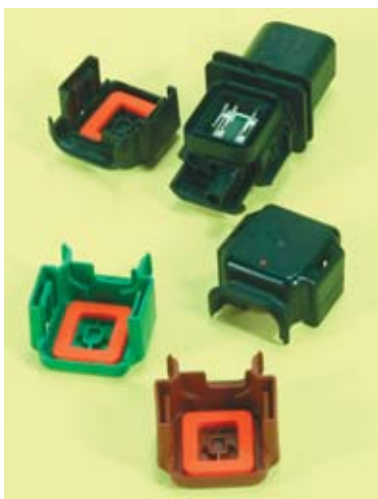
Der 2K-Deckel mit der LSR-Dichtung (rot) schützt die elektronische Schaltung der Steckverbindung dauerhaft vor Verschmutzung – eine Grundvoraussetzung für die zuverlässige Funktion der Lambdasonde im Lebenszyklus eines Autos.
