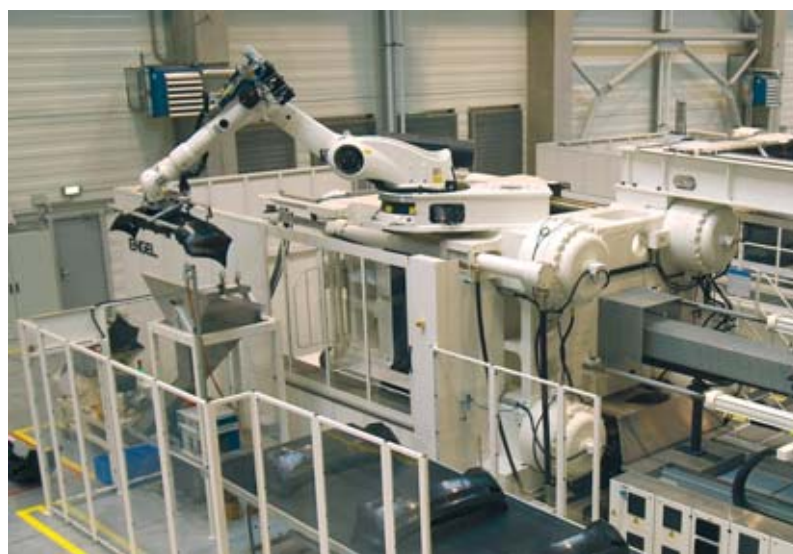
Mobis – In der Produktion werden unterschiedliche Robotersysteme gemäß ihren unterschiedlichen „Talenten“ eingesetzt: Lineargeräte für lange Transportwege und simultanes Einlegen und Entnehmen (links) – Industrieroboter für komplexe 3D-Bewegungen auf engem Raum (rechts).
