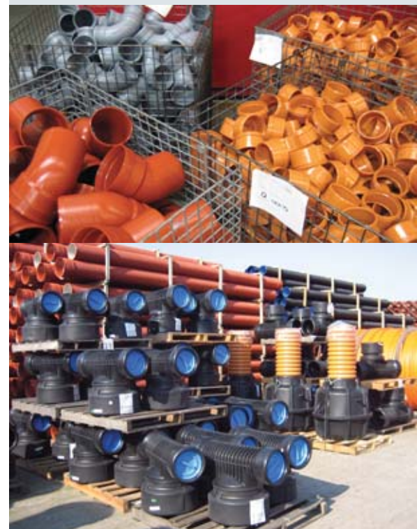
Nordisk Wavin – Die Produktpalette umfasst spritzgegossene Fittings und Muffen (Bild oben), extrudierte Rohre sowie zum Teil durch Rotationsgießen hergestellte Tanks und Sonderfittings (Bild unten).
