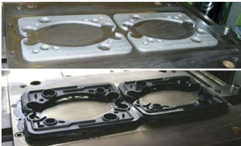
Auf einer der Elast V-Maschinen lief gerade die Produktion von Gummi-Metall-Verbundteilen in einem Vierfach-Kaltkanalwerkzeug – Zylinderkopfdichtungen für große Schiffsdieselmotoren (Bilder oben). Im Vergleich hierzu sind die mit dem hochmodernen optischen Messsystem im QS-Labor gerade geprüften, filigranen Perfluorelastomer-Edelstahl-Verbunde – es sind Lamellen für Mikroventile – richtige Winzlinge (Bilder unten). Beim Spritzgießen im 12-fach-Werkzeug reichen hierfür wenige Gramm Schussgewicht – einschließlich Angussverteiler. Aber die gilt es exakt reproduzierbar zu dosieren.
