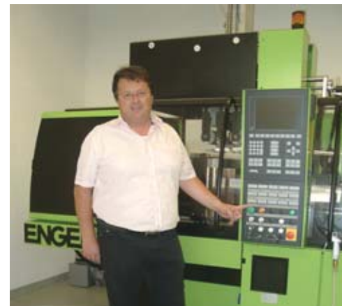
Jürgen Ohr vor der neuen ENGEL VICTORY 200/40 Tech (Schließkraft 400 kN): „Wir legen Wert auf größtmögliche Flexibilität und haben diese Horizontalmaschine daher modular für den Thermoplast-, Gummi- und den LSR-Spritzguss ausgerüstet.“
