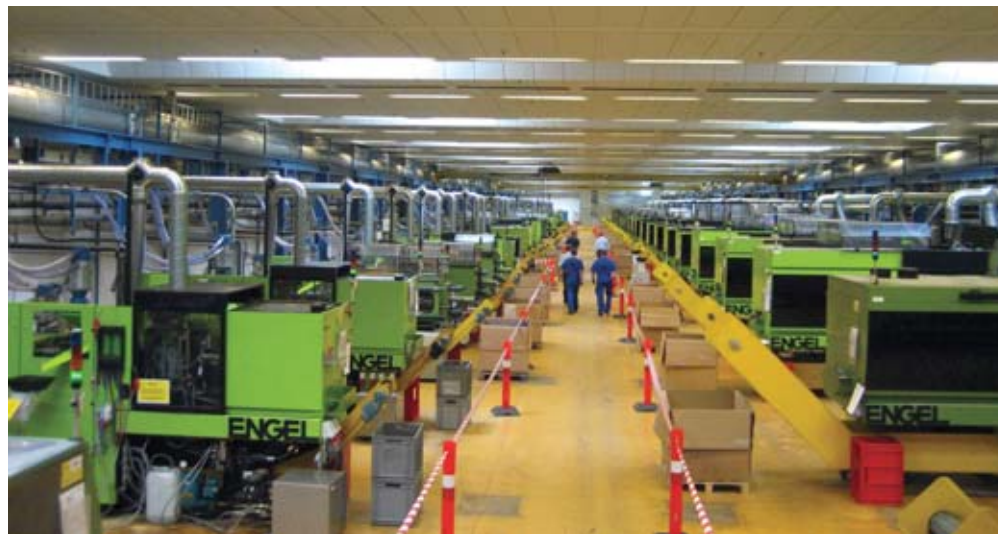
uni-chains – Die für die Förderbänder benötigten „Systembausteine“ sind heute in der Mehrzahl Spritzgussteile unterschiedlichster Größen (Bild links). Bild Mitte: Die neue Spritzgießhalle (Teilsicht) mit 70 Engel Spritzgießmaschinen. Bild rechts: Förderketten von uni-chains werden auch für gewichtige Aufgaben eingesetzt, z.B. den Transport von Autos im Montagewerk.
