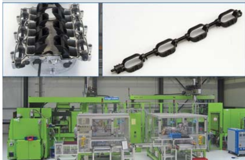
Schneegans: Die Schaltklappen (oben rechts) für die Luftsaugsysteme von V6- (oben links) und V8-Motoren entstehen auf zwei miteinander verketteten 2K-Holmlosmaschinen mit 3.000 und 1.300 kN Schließkraft. Das zweite Spritzaggregat der 1.300 kN-Maschine ist als Gummi-Spritzaggregat ausgeführt.
