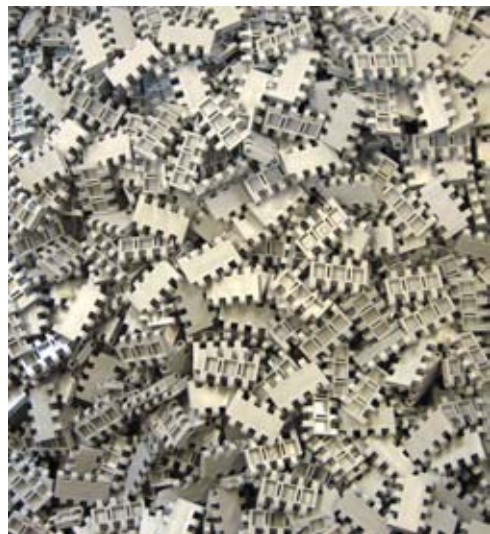
uni-chains – Die für die Förderbänder benötigten „Systembausteine“ sind heute in der Mehrzahl Spritzgussteile unterschiedlichster Größen (Bild links). Bild Mitte: Die neue Spritzgießhalle (Teilsicht) mit 70 Engel Spritzgießmaschinen. Bild rechts: Förderketten von uni-chains werden auch für gewichtige Aufgaben eingesetzt, z.B. den Transport von Autos im Montagewerk.
