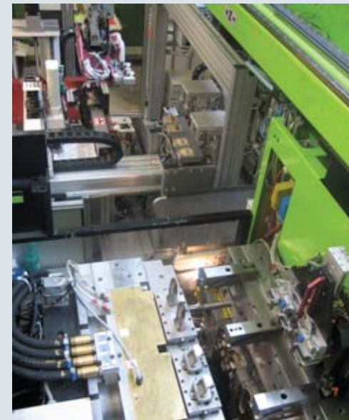
Philips DAP: Das 2+2-fach Indexplatten-Gruppenwerkzeug für den Epilierer-Kühlakku (gespritzt werden parallel jeweils zwei Kühlgel-Vorratsbehälter und zwei Verschlussdeckel mit integrierter Metallplatte) wiegt 1.650 kg und passt auf eine „hochgerüstete“ ENGEL VICTORY mit lediglich 90 t (900 kN) Schließkraft.
