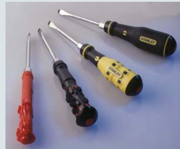
McKechnie – Der mehrschichtige Handgriff des Stanley-Schraubendrehers: PA (rot), PP (schwarz + gelb) und TPE (schwarz).
