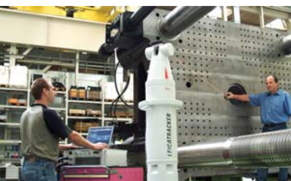
Veressen einer Aufspannplatte mit dem 3D-Laser-Tracker, einer u. a. im Flugzeugbau eingesetzten, hochgenauen Prüfeinrichtung.
