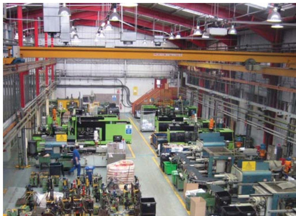
Hepworth – Produktionsbereich zur Herstellung von Abwasserfittings aus PP und ABS.
