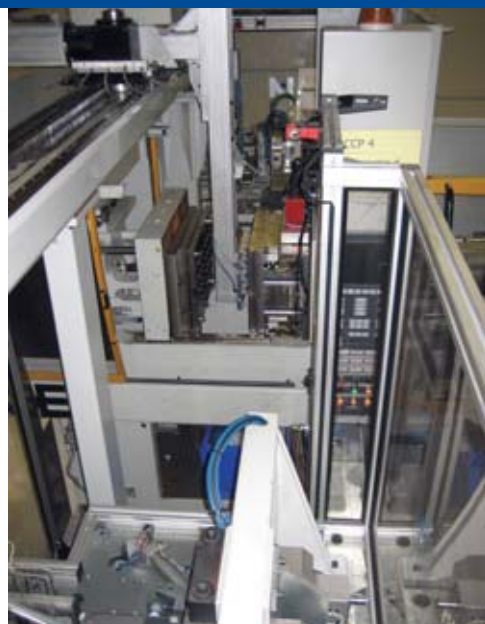
McKechnie – Bild links: Widget-Produktionszellen in Reih und Glied. – Bilder Mitte und rechts: Mit Linear- und Industrierobotern voll automatisierte Formteilentnahme und Weiterverarbeitung der Halbkugelschalen durch Heizspiegelschweißen.
