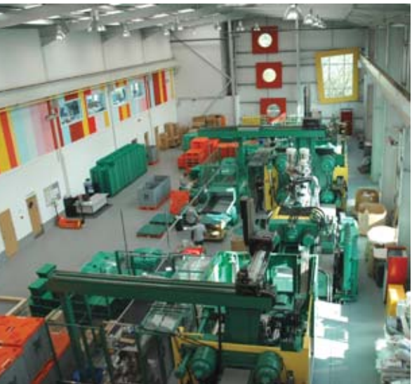
Loadhog – MuCell-Spritzgießen der Palettendeckel (oben). – Bild unten: Der innovative Palettendeckel mit integrierten Spanngurten.
