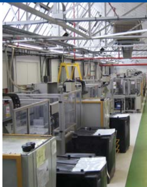
McKechnie – Bild links: Widget-Produktionszellen in Reih und Glied. – Bilder Mitte und rechts: Mit Linear- und Industrierobotern voll automatisierte Formteilentnahme und Weiterverarbeitung der Halbkugelschalen durch Heizspiegelschweißen.
