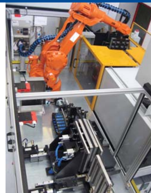
McKechnie – Bild links: Widget-Produktionszellen in Reih und Glied. – Bilder Mitte und rechts: Mit Linear- und Industrierobotern voll automatisierte Formteilentnahme und Weiterverarbeitung der Halbkugelschalen durch Heizspiegelschweißen.
