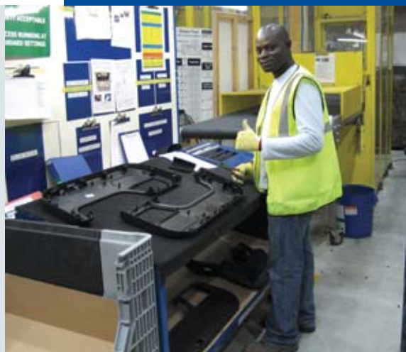
... mit einem „Türspiegel“ mit einer Außenhaut aus TPO/PE-Schaum – Bild rechts: Türspiegel-Montage.
