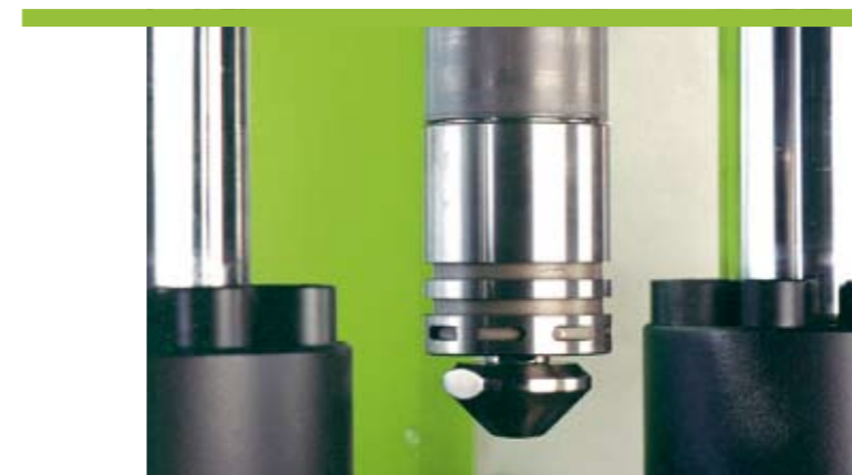
Pistone di iniezione del gruppo FIFO ENGEL in posizione di massima estensione
