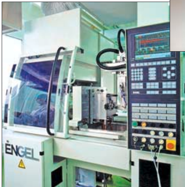
Die Engel ES 80/45 HL mit 450 kN Schließkraft und integriertem Entnahmehandling (ER-HLi 21) im Reinraum von Samaplast hat auch eine umfangreiche Softwareausrüstung. Eine 100-Prozent Qualitätsüberwachung und lückenlos rückverfolgbare Dokumentation ist zum Beispiel bei Medizinprodukten Pflicht
