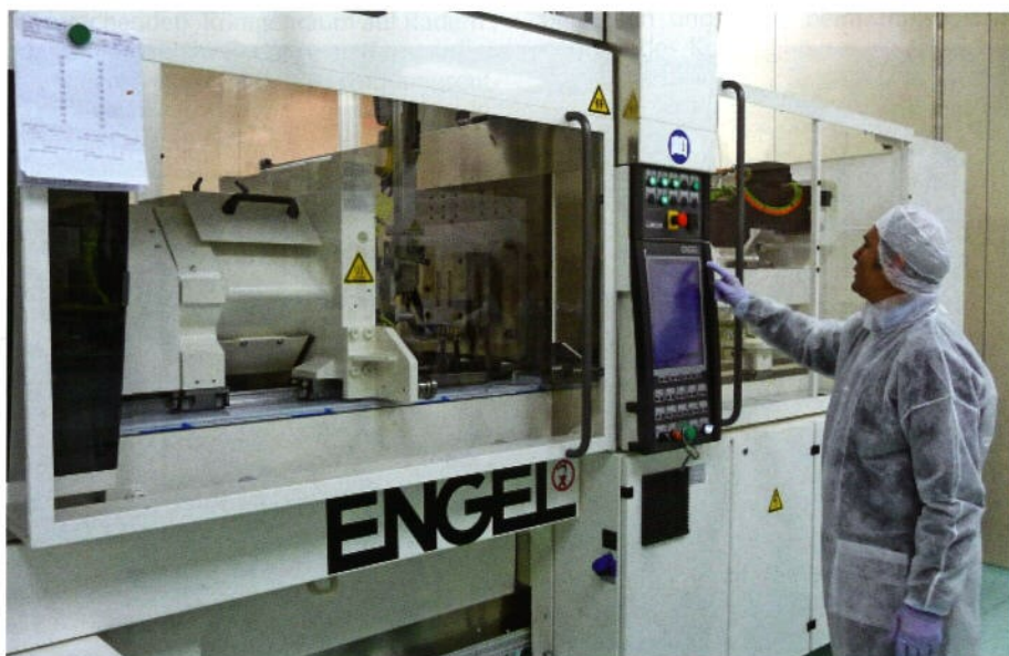
Die vollelektrischen Maschinen vom Typ Engel e-motion arbeiten besonders sauber und präzise, zwei wichtige Aspekte bei der Kaufentscheidung. Foto: Engel
