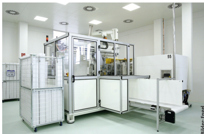
Drei Engel e-max 180 produzieren die Racks in denen die Tips & Cups abgelegt werden.
