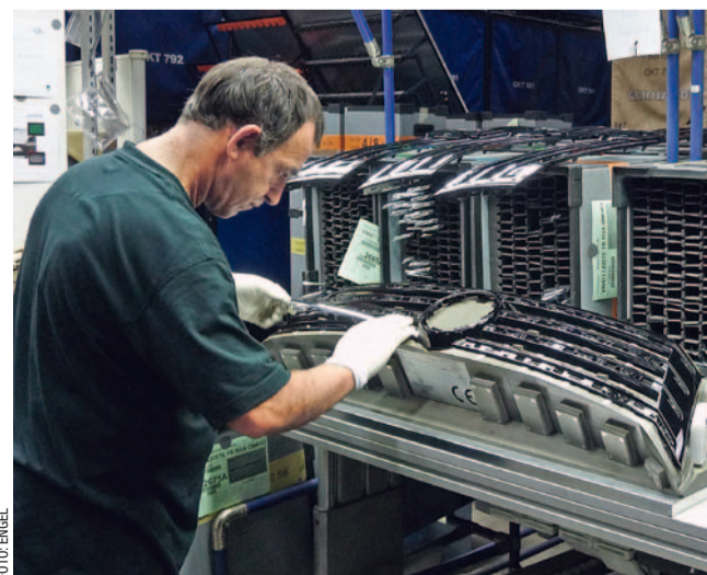
Kurze Wege: Die Montage erfolgt unmittelbar nach dem Spritzguss der Trägerteile in der Spritzgießmaschinenhalle
