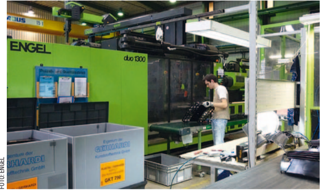
Die Engel Duo 1300 Maschinen fertigen die Trägerteile für die Passat B7-Kühlergitter (rechts im Bild). Das Förderband unmittelbar vor der Maschine nimmt Bauteile einer anderen Großmaschine auf. Platz ist in der Fertigungshalle in Ibbenbüren Mangelware
