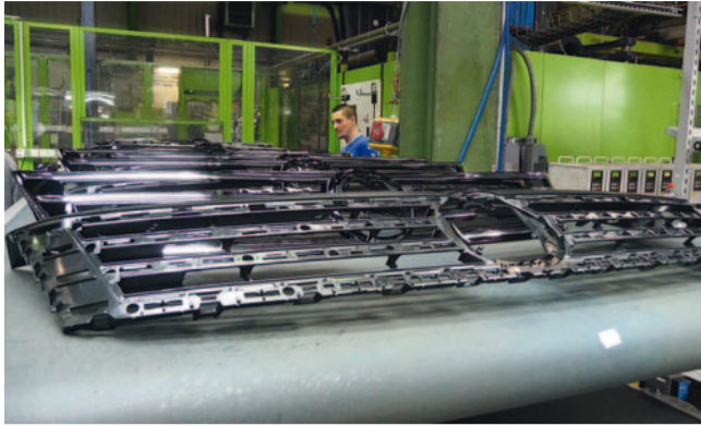
Die Blenden der Kühlergitter werden auf einer 8.000-kN-Maschine gespritzt und hochglänzend lackiert
