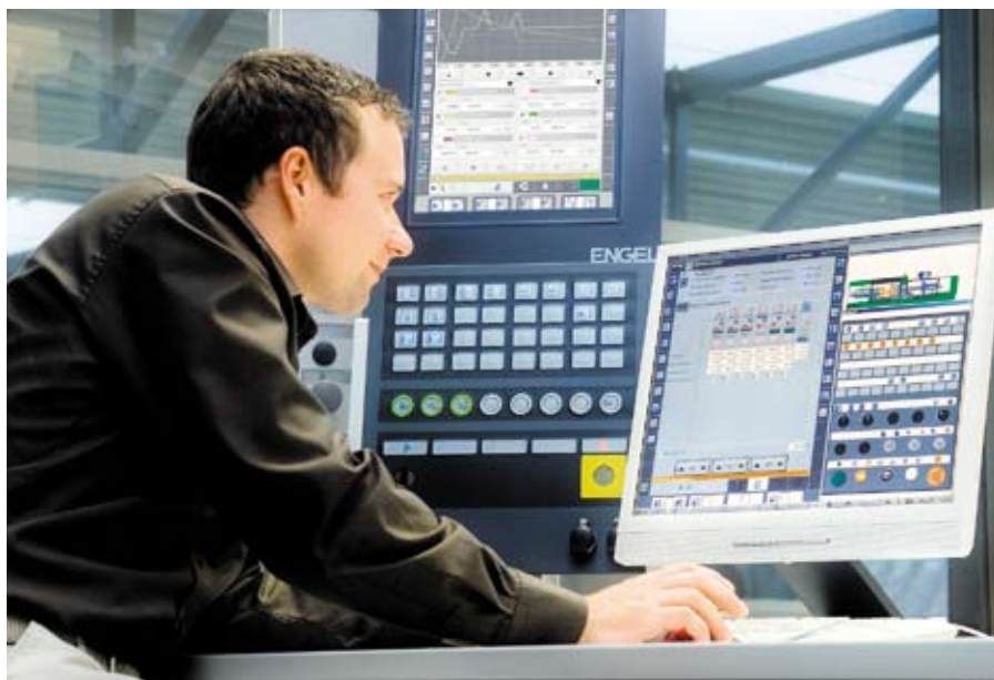
Рис. 2. Для программирования процесса смены формы используются специальные программные модули. Это программирование может осуществляться как в режиме online непосредственно на литейной машине, так и в режиме offline на отдельном компьютере (фото: ENGEL)
