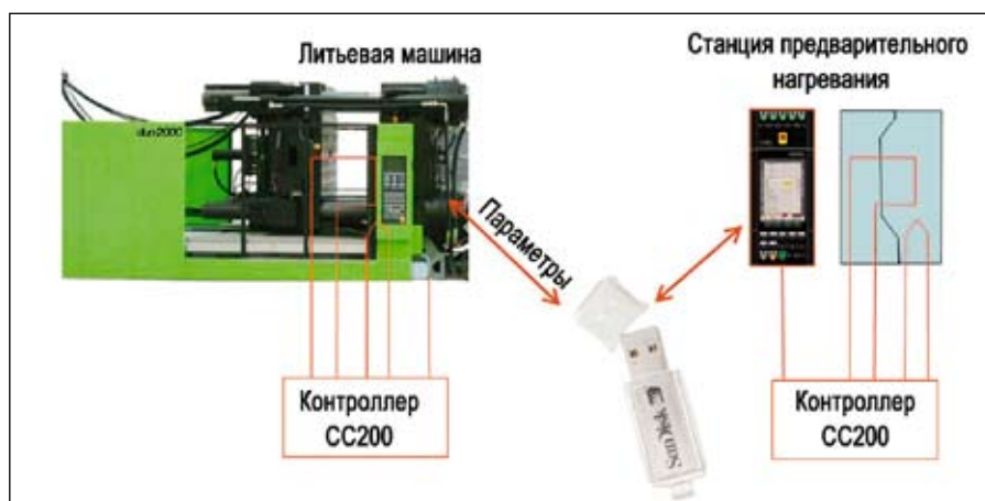
Рис. 3. Быстрый предварительный нагрев литейной формы до рабочей температуры является важнейшей предпосылкой для быстрого переключения литейной машины на выпуск продукции другого вида. Управление термостатирующими приборами и системой обогрева горячих каналов осуществляется с помощью программных модулей системы программного обеспечения управления литейной машиной (рисунок: ENGEL)
