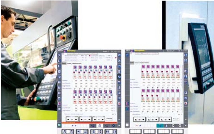
Рис. 4. Панель управления терминала станции предварительного нагрева по логике использования соответствует системе управления литьевой машины (фото: ENGEL)
