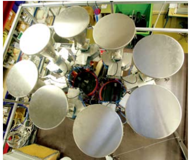
Рис. 3. Каждый из двух узлов пластикации установки e-compounder включает в себя четыре смешивательных устройства, благодаря чему имеется возможность дозирования до восьми различных компонентов компаунда ПМ (фото: ENGEL)
