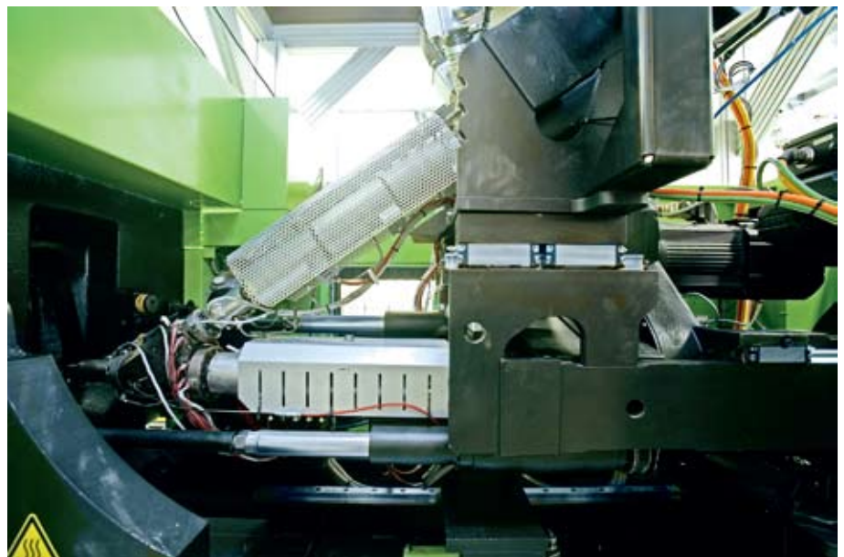
Рис. 4. Основой установки e-compounder стала электрическая литьевая машина серии ENGEL e-motion, а ее главным узлом – имеющая форму буквы Y смешивательно-гомогенизирующая система (фото: ENGEL)
