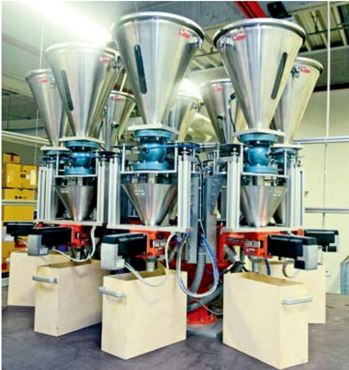
Рис. 3. Каждый из двух узлов пластикации установки e-compounder включает в себя четыре смешивательных устройства, благодаря чему имеется возможность дозирования до восьми различных компонентов компаунда ПМ (фото: ENGEL)
