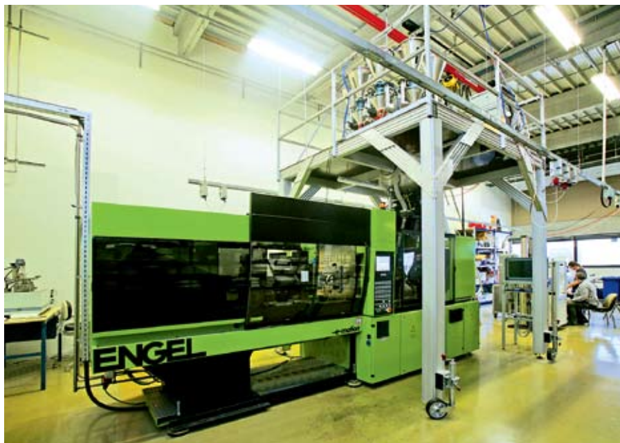
Рис. 5. Интегрирование компаундера в серийный узел пластикационной электрической литьевой машины открывает широкие возможности для экономичного производства изделий с индивидуализированными характеристиками (фото: ENGEL)
