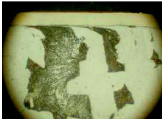
Рис. 5. На образцах плит (рисунок слева, сверху), подвергнутой очистке хлороксином в течение 60 мин, повреждений не наблюдается. Справа – полученное с помощью микроскопа для исследования в отраженном свете изображение (60-кратное увеличение) поперечного сечения, сделанное для анализа качества покрытия и его соединения с поверхностью металла; отчетливо видно, что покрытие имеет монолитную структуру и гладкую поверхность
