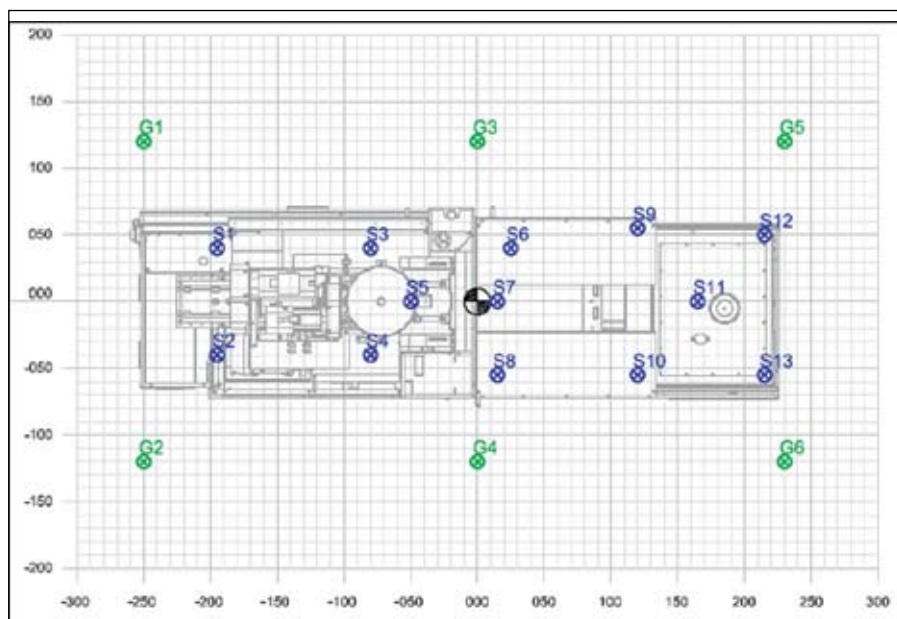
Рис. 2. Пригодность литейной машины для ее использования в чистом помещении проверяют путем измерения содержания частиц загрязняющих веществ и визуализации потока воздуха. Измерения выполняются одновременно во многих контрольных точках, расположенных непосредственно на машине и за ее пределами (иллюстрации: Engel)
